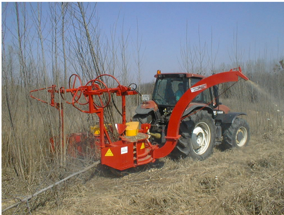
4.12. sz. kép: Optigép Kft. által kifejlesztett rendvágó gép, Tata, 2005.
