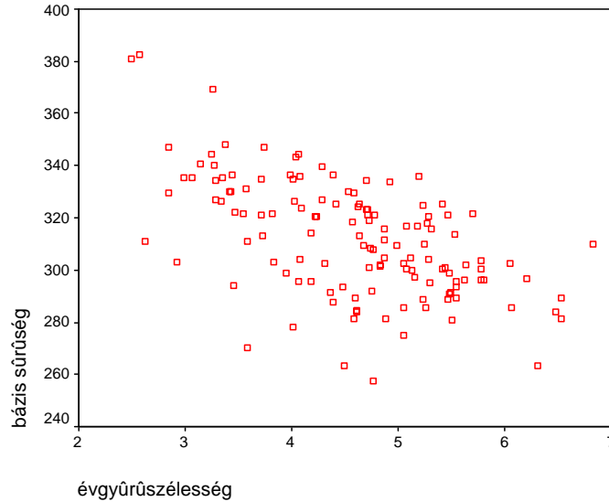
5.36. ábra – Lucfenyő mintatörzsek bázissűrűségének [ \text{kg/m}^3 ] változása az évgűrűszélesség [mm] függvényében (korrelációs együttható: -0,575)
