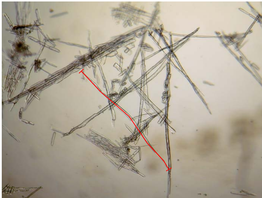
3.4. ábra – Tracheida hosszúságának mérése Image-Pro Plus 4.0. számítógépes program segítségével (fotó: Paukó A.)
