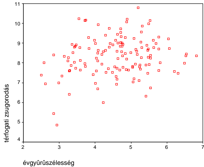
5.40. ábra – Lucfenyő mintatörzsek térfogati zsugorodásának [%] változása az évgyűrűszélesség [mm] függvényében (korrelációs együttható: 0,195)
