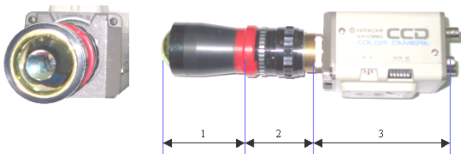
Abbildung 68: Front- und Seitenansicht des 360°-Systems (1: Panoramic Annular Lens, 2: Kollektorlinse, 3: CCD-Kamera)
