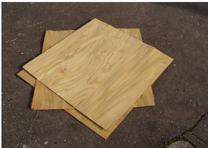
9. ábra: Hámozási eljárással készült 1,5 mm vastag akác furnérok
