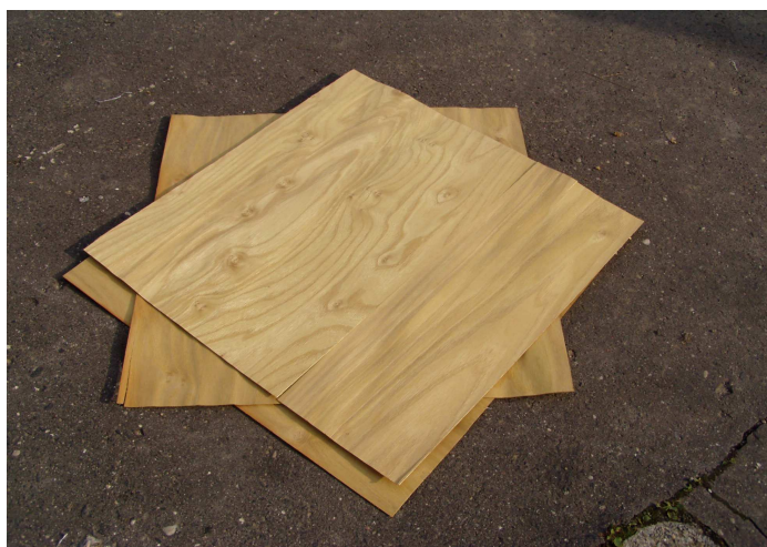
7. ábra Hámozási eljárással készült 1,56 mm vastag akác furnérok
