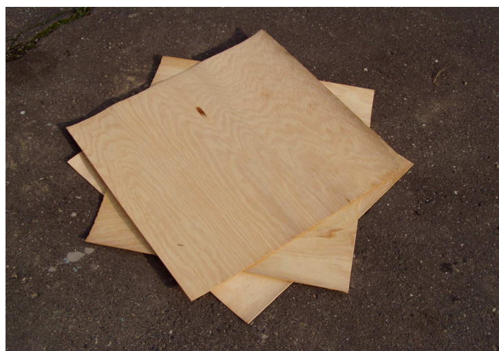
10. ábra Hámozási eljárással készült 2,0 mm vastag pinus (erde fenyő) furnérok
