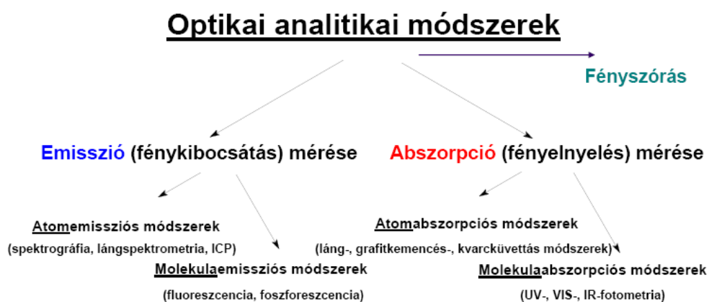
17. ábra: Optikai analitikai módszerek csoportosítása 114
