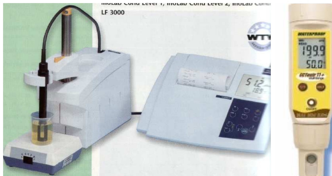
3. kép: Laboratóriumi és kézi konduktométer 112
