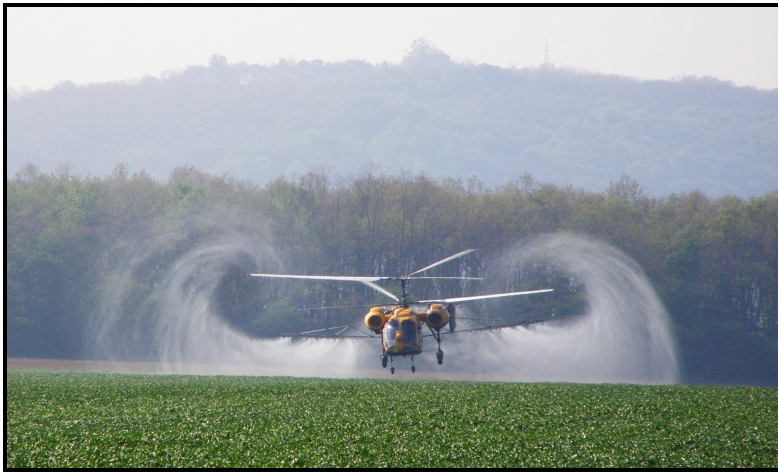
27. ábra: Kamov KA-26 permetező helikopter
