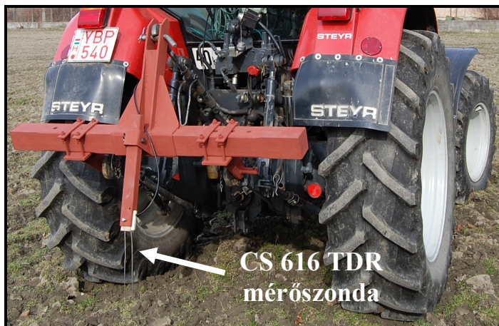
2. ábra: A speciális függesztőkeretre szerelt mérőszonda
