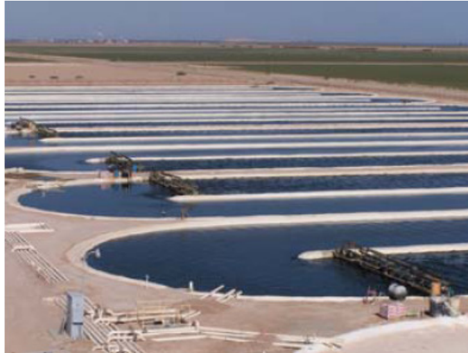
5. ábra: Spirulina nagyüzemi előállítására használt szabadtéri medencék az Earthrise Farmon (Calipatria, California) ( url 6 )
