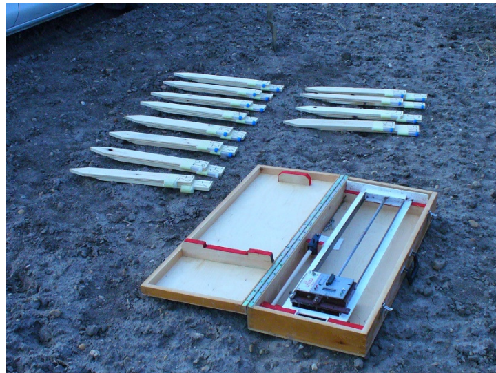
10. ábra Talajellenállás és vízkapacitás mérő eszköz. Termőhelyi Talaj Teszter (3T System)
