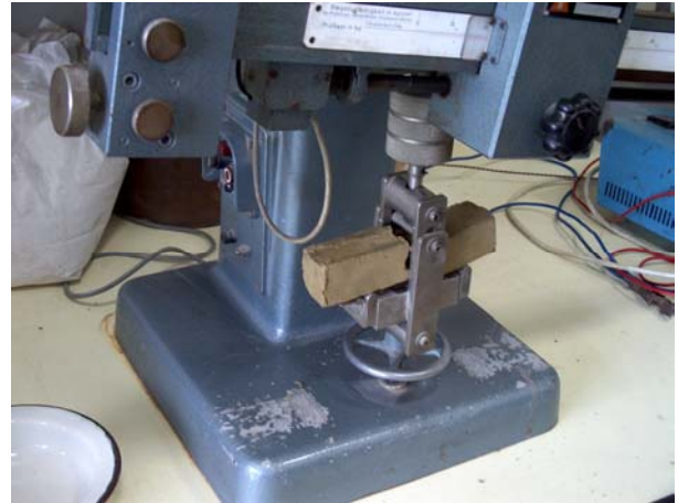
7.5. kép: Kvázi húzószilárdság vizsgálat
