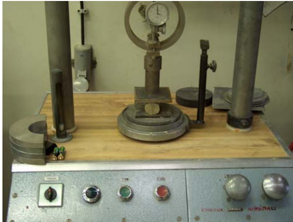
7.5. kép: Kvázi húzószilárdság vizsgálat
