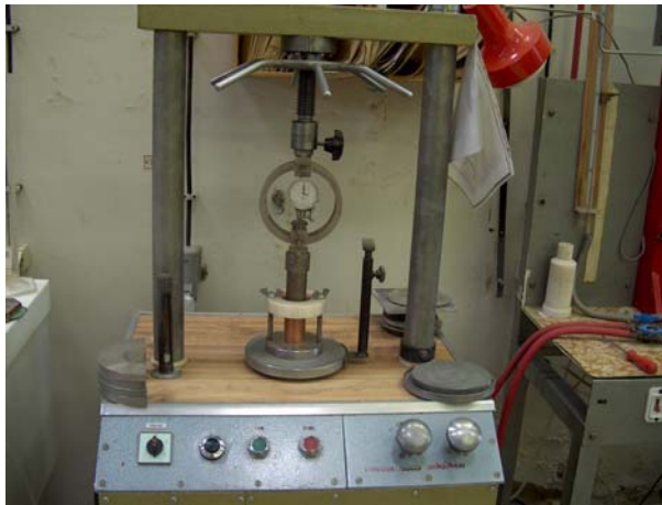
7.3. kép: Préselt hengeres próbatest:
