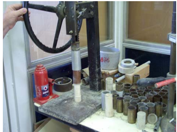
7.3. kép: Préselt hengeres próbatest:
