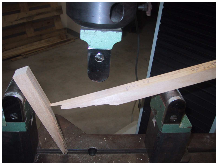
12. ábra: Harántrost törés (FOTÓ: KATONA)
