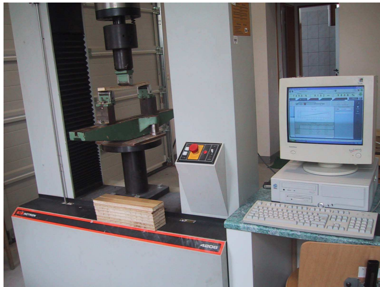
15. ábra: INSTRON 4208 univerzális anyagvizsgáló berendezéssel (FOTÓ: KATONA)
