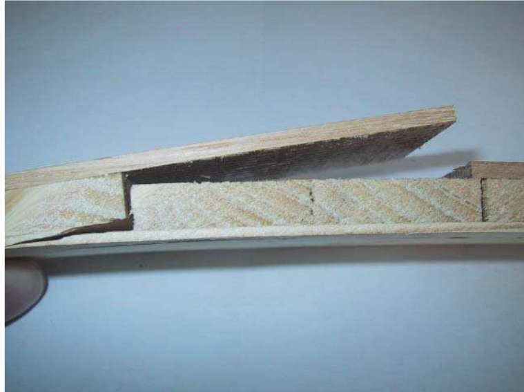
17. ábra: Felsőréteg ragasztási "gyengesége" (FOTÓ: KATONA)
