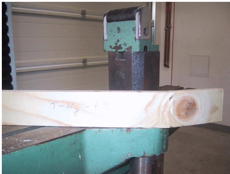
19. ábra: Alsóréteg göcsössége 2. (FOTÓ: KATONA)
