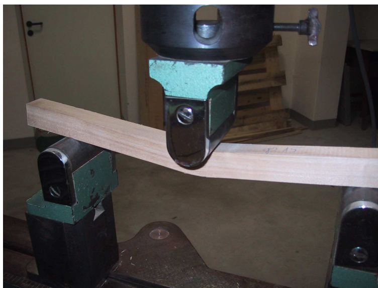
9. ábra: Hajlítószilárdsági vizsgálat (FOTÓ: KATONA)
