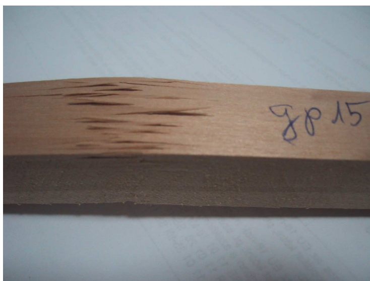
11. ábra: Szálkás törés (FOTÓ: KATONA)
