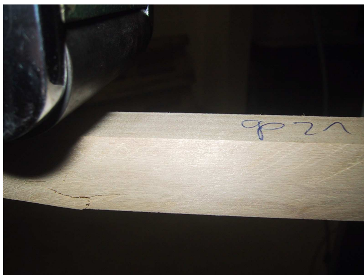
13. ábra: Rideg törés (FOTÓ: KATONA)
