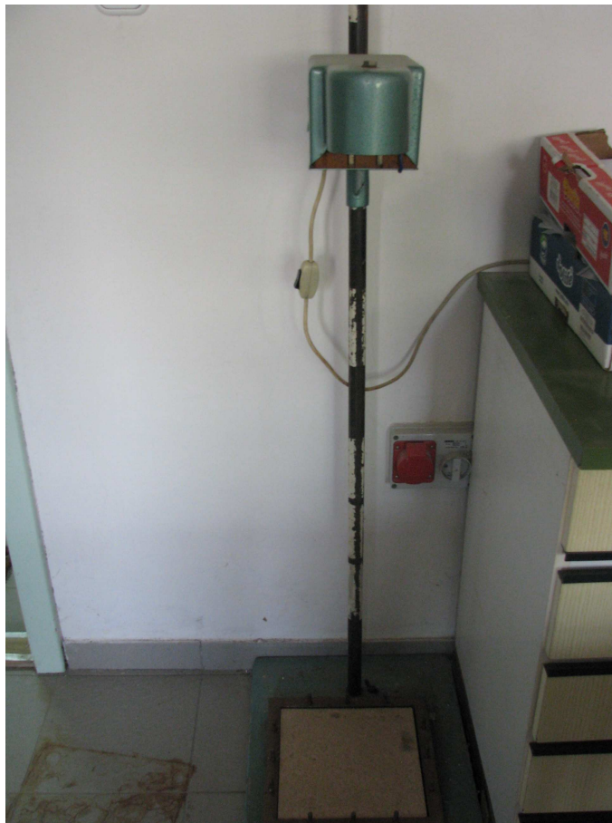
21. ábra: Ütésállóság vizsgáló ejtő golyós berendezés (FOTÓ: KOROKNAI)
