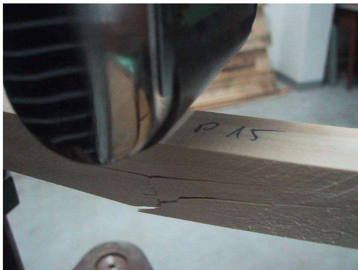
10. ábra: Húzott öv egyszerű törése (FOTÓ: KATONA)
