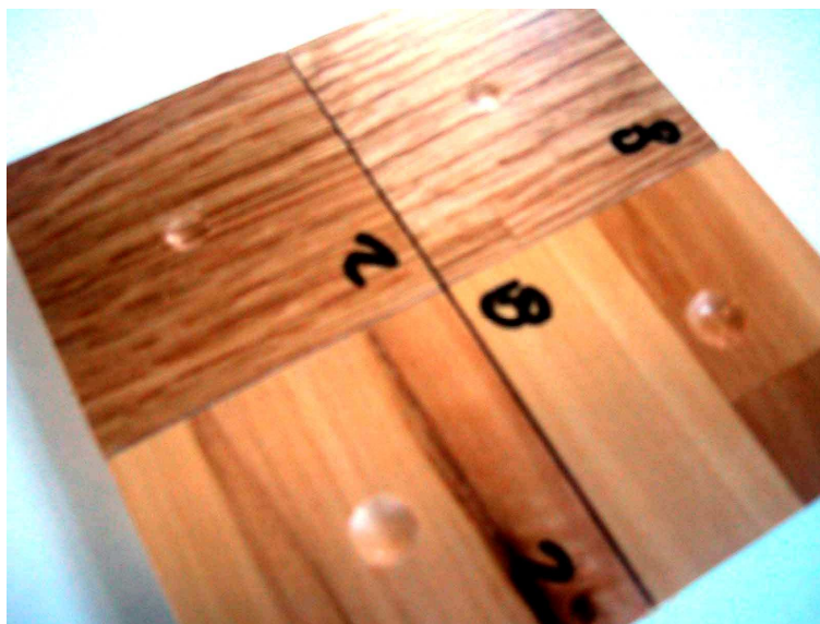
20. ábra: Brinell-vizsgálat eredménye tölgy és nyár szalagparkettán (FOTÓ: KATONA)
