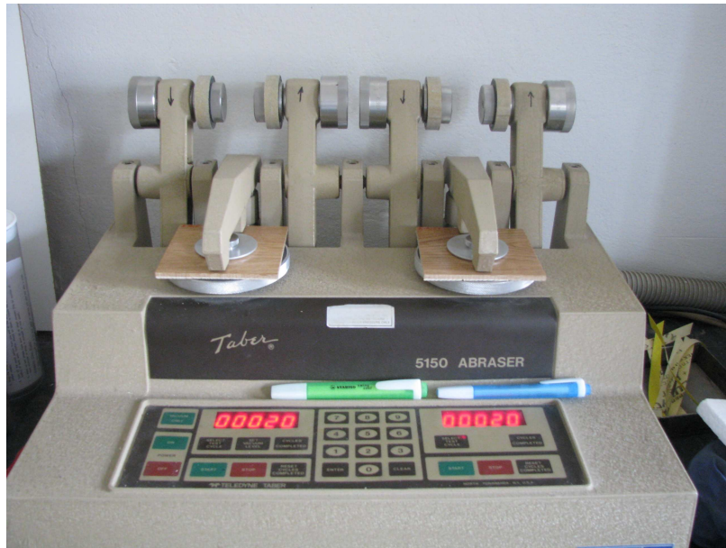
23. ábra: Taber-féle kopásállóság vizsgálógép (FOTÓ: KOROKNAI)
