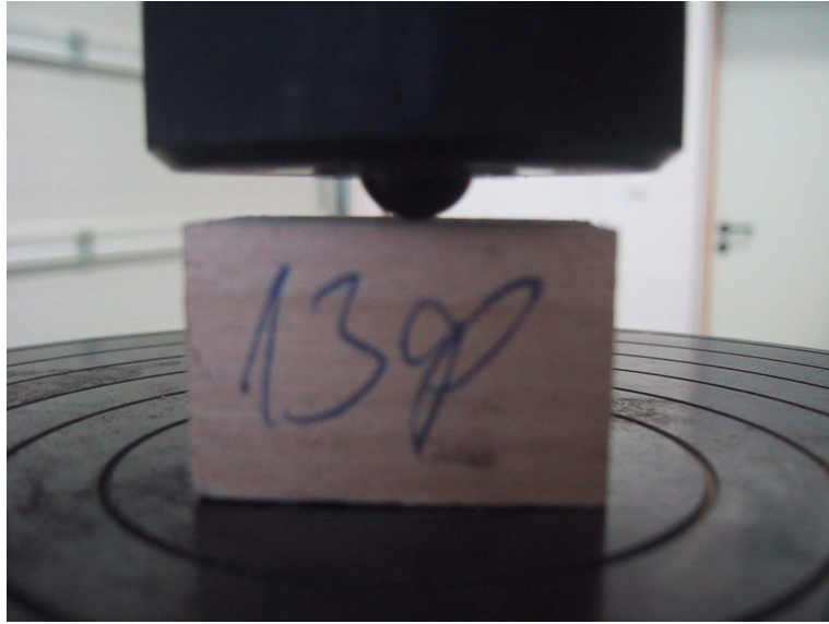
14. ábra: Brinell-Mörath-féle keménység vizsgálat (FOTÓ: KATONA)
