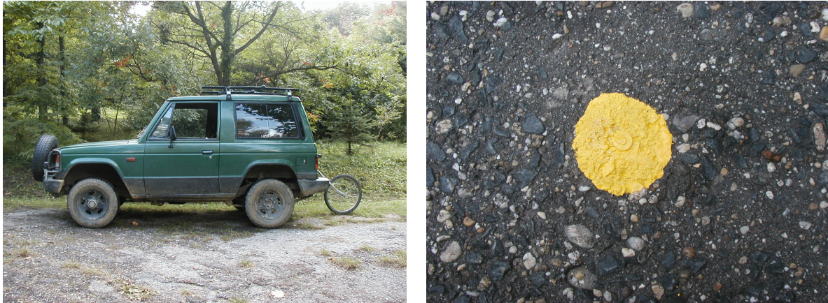
3.5. ábra. Mérőkocsi (a) és a jellemző pontok (b) állandósítására alkalmazott burkolatjel.
