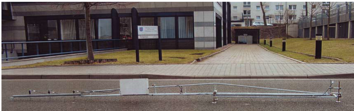
5.13. ábra. Automatizált Benkelman-tartó, Németország (Dähnert, 2005).
