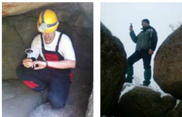
4.3. ábra. Szélsébség mérése a Zsivány-barlangban és a bejáratánál (Képek forrása: Bekk Tímea)
