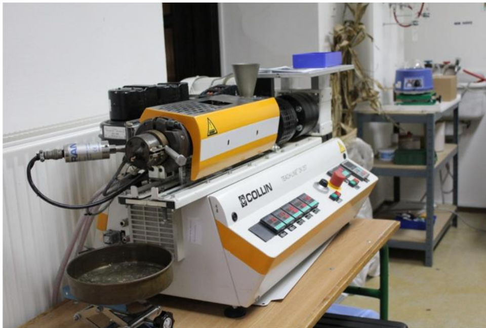
38.ábra COLLIN ZK25T ikercsigás laboratóriumi extruder
