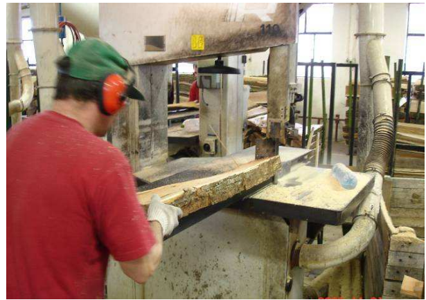
3. ábra – A dongafríz kialakítása (fotó: Taschner R.)
