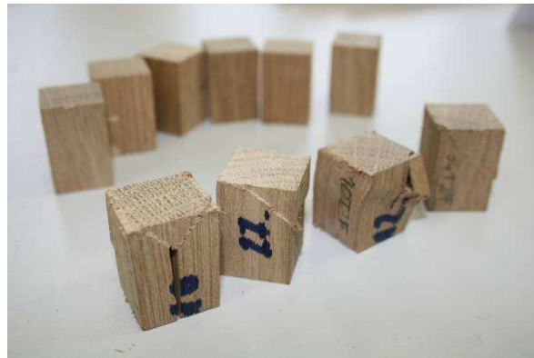
19. ábra – A nyomó igénybevétel okozta tönkremenetel törésképei
