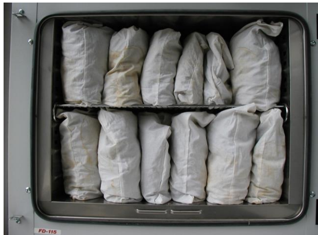
e.) Nedves avarminták súlymérés után a szárítószekrényben
