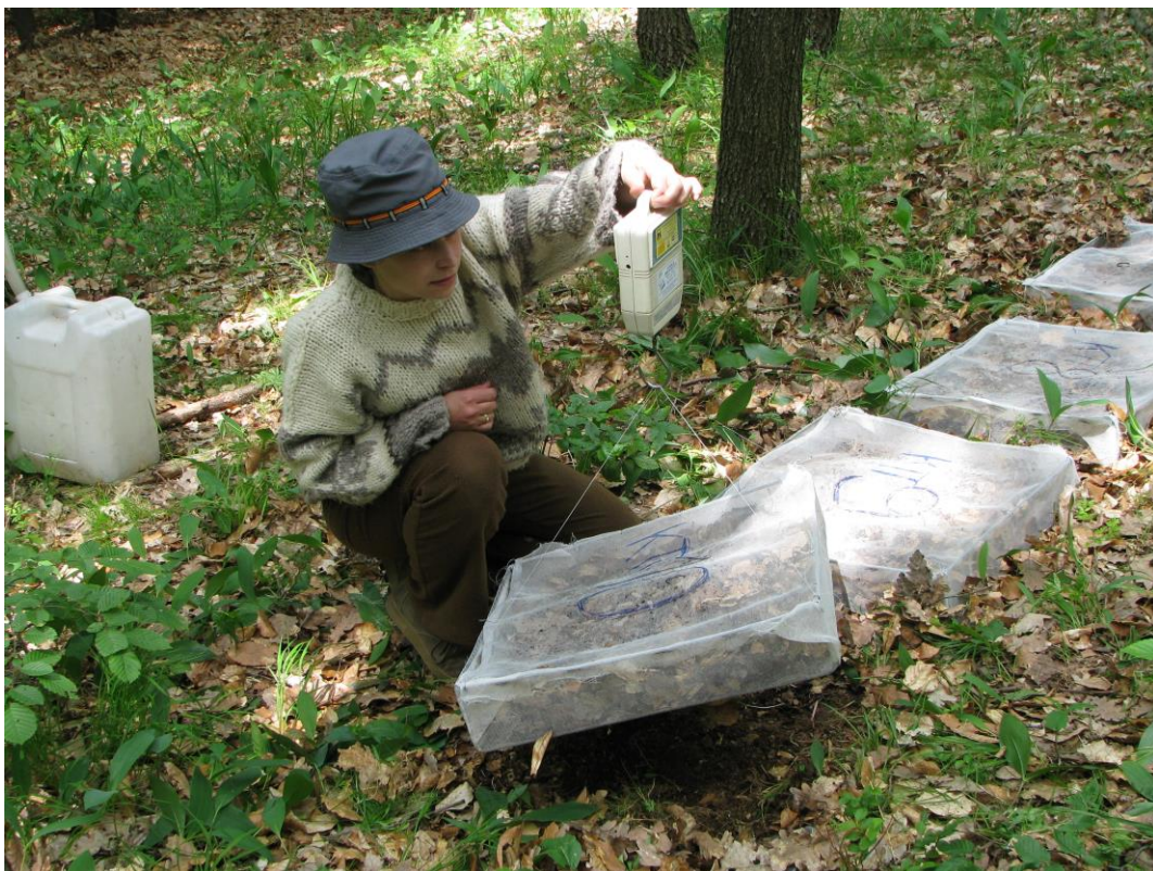
5./XI. ábra. „Keretes” mérés a tölgyes intercepciós kertben.
