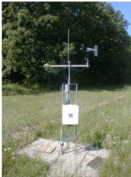
3.7. ábra. Campbell Scientific CR10 típusú adatgyűjtőt tartalmazó meteorológiai állomás a Széchenyi István Geofizikai Observatóriumban
