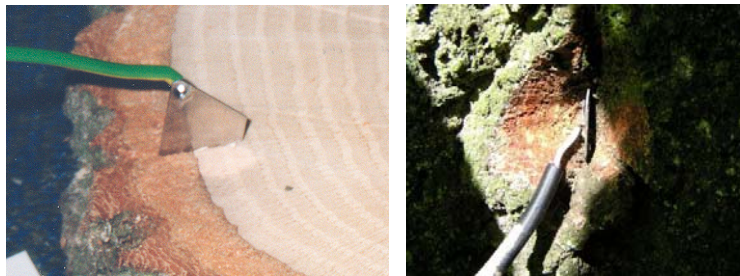
3.4. a-b. ábra. (a) az elektromos potenciálkülönbség-méréshez használt elektród beültetési modellje; (b) egy beültetett elektród
