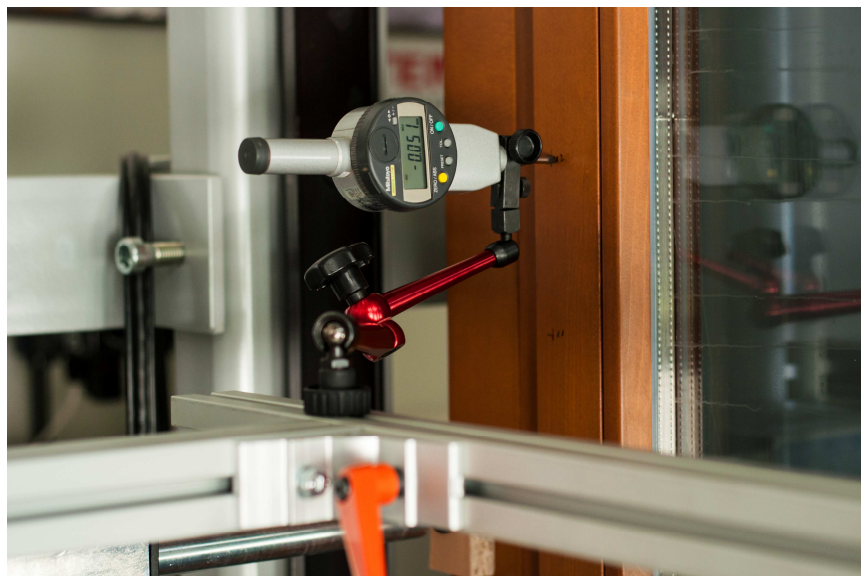
52. ábra Szárny elmozdulásának mérése 600 Pa túlnyomás alkalmazása során
