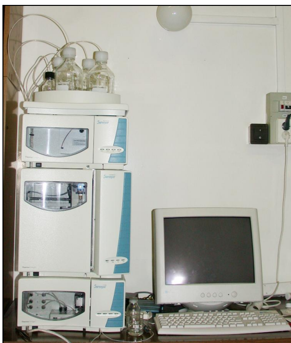
22. ábra. A lobelin meghatározásához használt Surveyor HPLC készülék. (Budapest, Semmelweis Egyetem) (Fotó: Vojnich, 2012)
