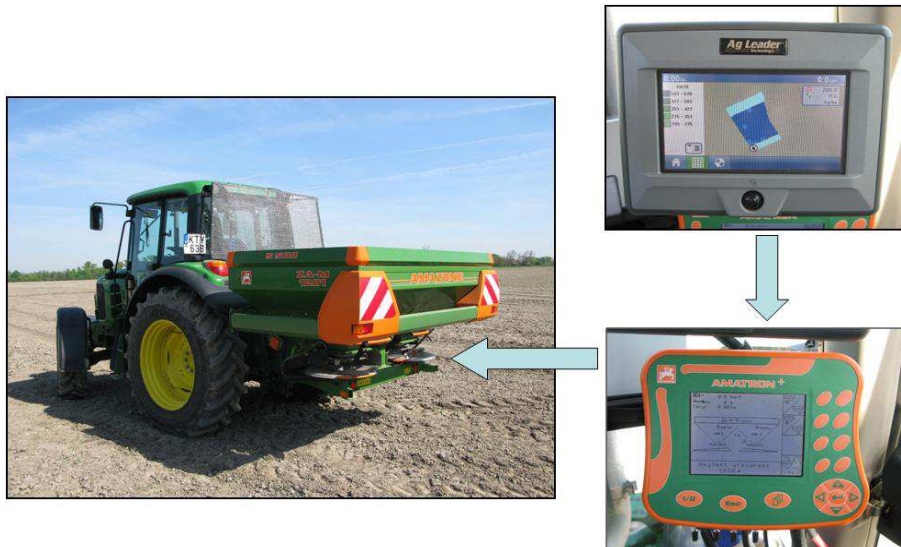
9. ábra: A helyspecifikus kijuttatás-vezérlő rendszer felépítése
