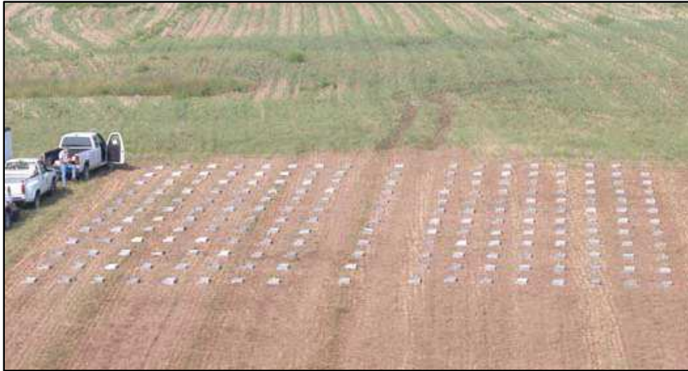
3. ábra: Szántóföldi vizsgálat mérőedények segítségével FULTON ÉS MTSAI, (2006)
