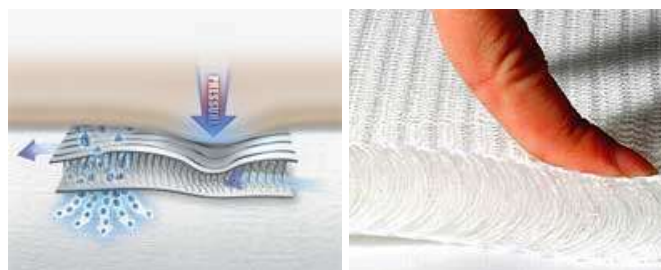
2.16 ábra: Üreges körkötött kelme keresztmetszete (Liu Y., H. Hu 2011)
