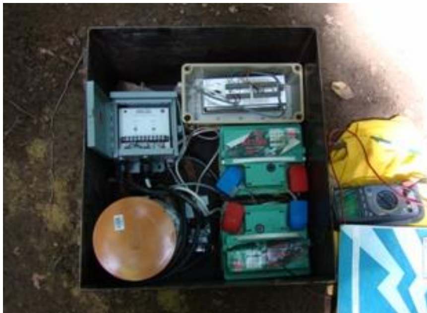
18. ábra. A soproni teszterületen telepített dőlésmérő és tartozékai
