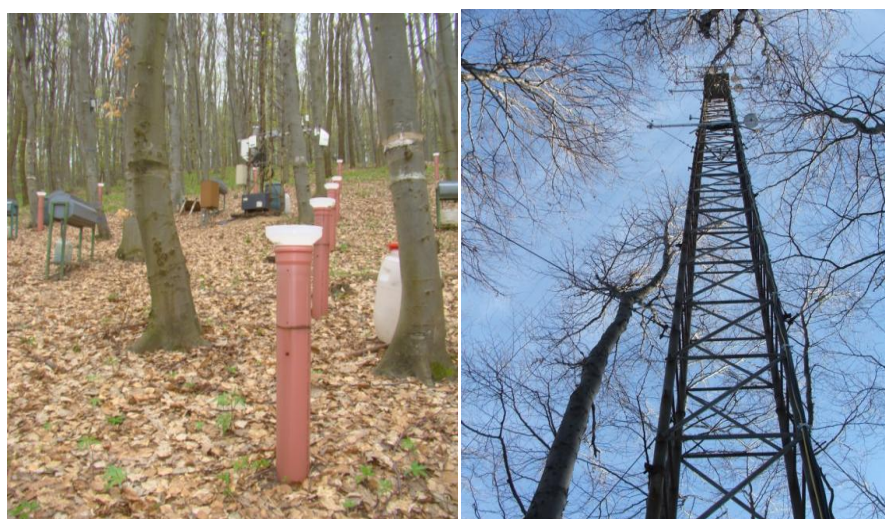
20. ábra. A vizsgálati területen elhelyezett intercepciós mérőedények és a mérőtorny felső szintjeinek szenzor-konzolai
