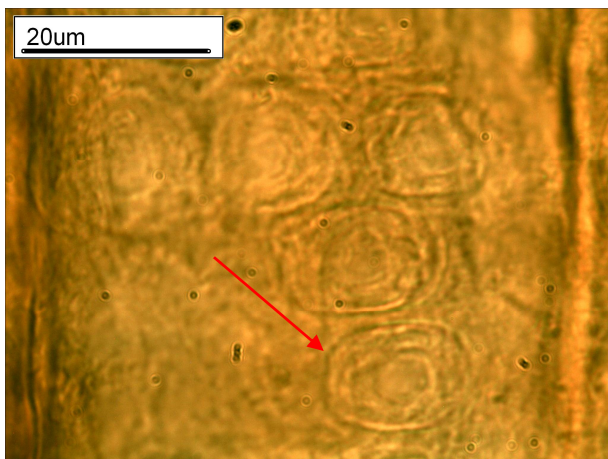
65. ábra Az udvarosgödörkék 2-3 sorban láthatók a hossztracheidákban (10-es minta)
