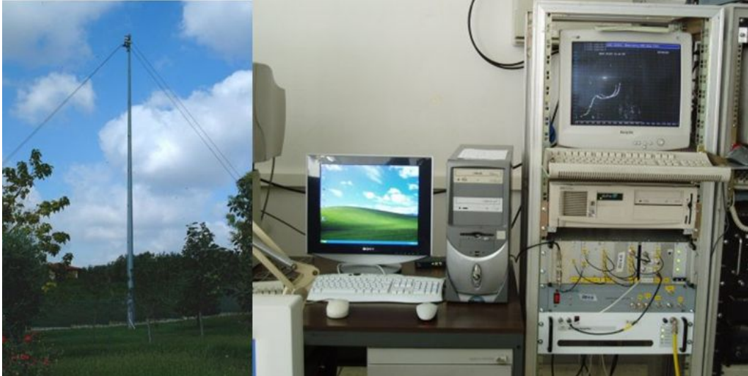
32. ábra. A bal oldalon a vertikális szondázásra szolgáló antennapár egyike, a jobb oldalon pedig az AIS-INGV digitális ionoszonda berendezés.
