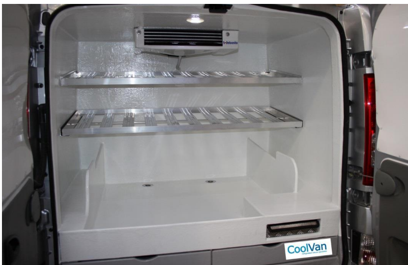
11.melléklet: Palackozott tejet szállító gépkocsi hűtött raktere (Forrás: internet)
