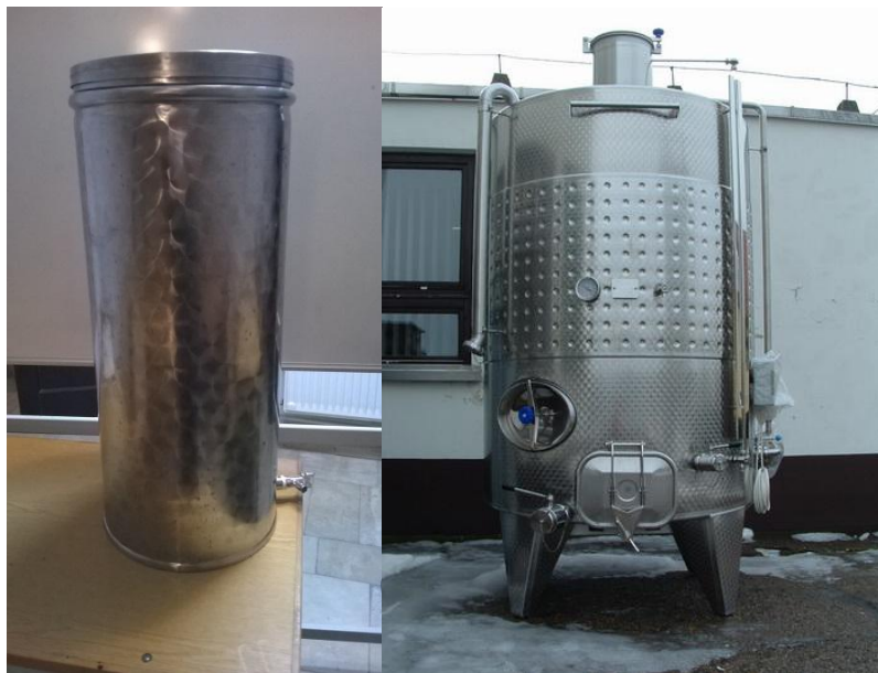
12. ábra: A saválló acél erjesztő tartályok sima (saját felvétel), és kettős falú (URL 4 ) kivitelben.
