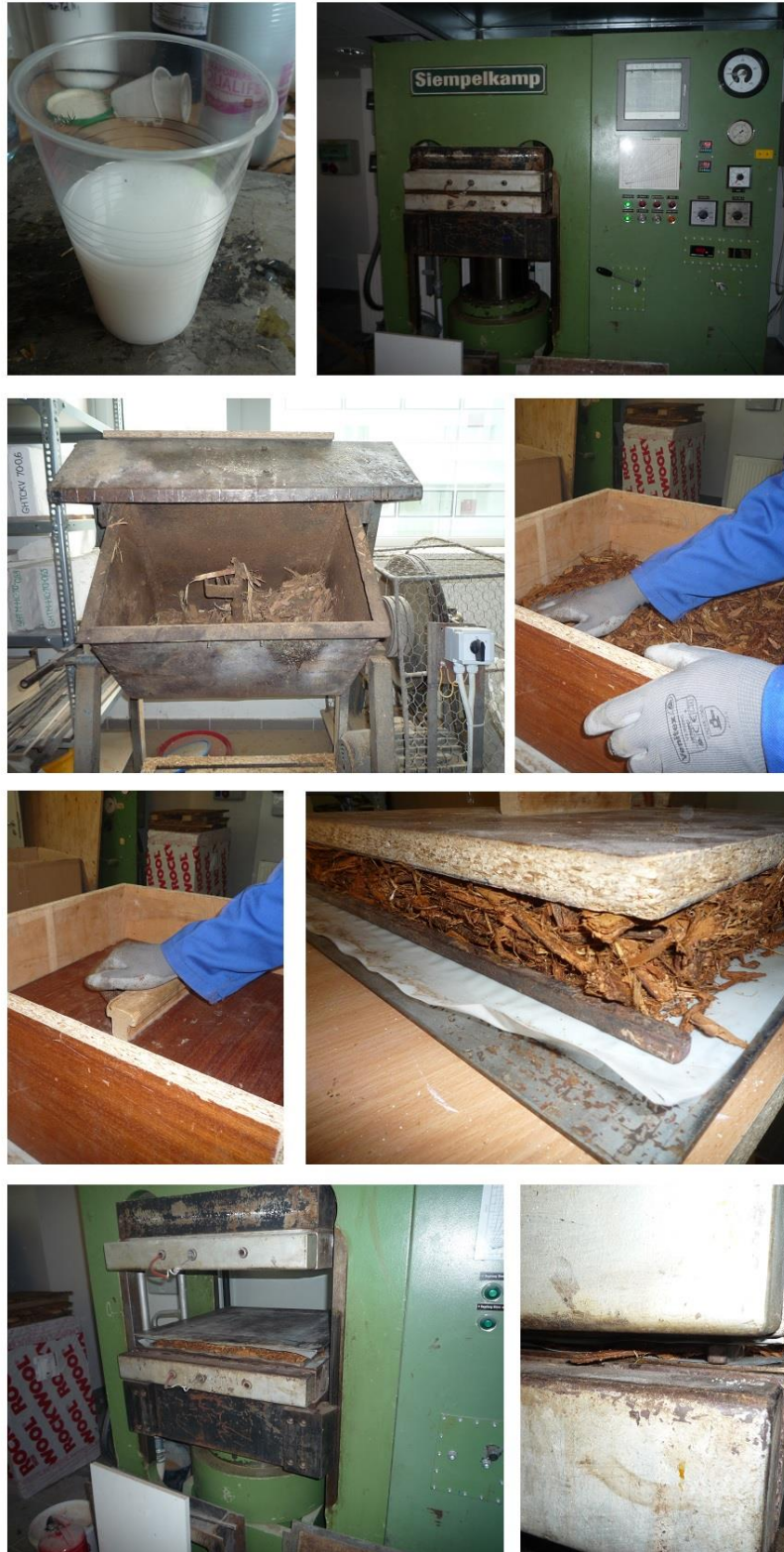
18. ábra A kéreglapok készítésének folyamata
