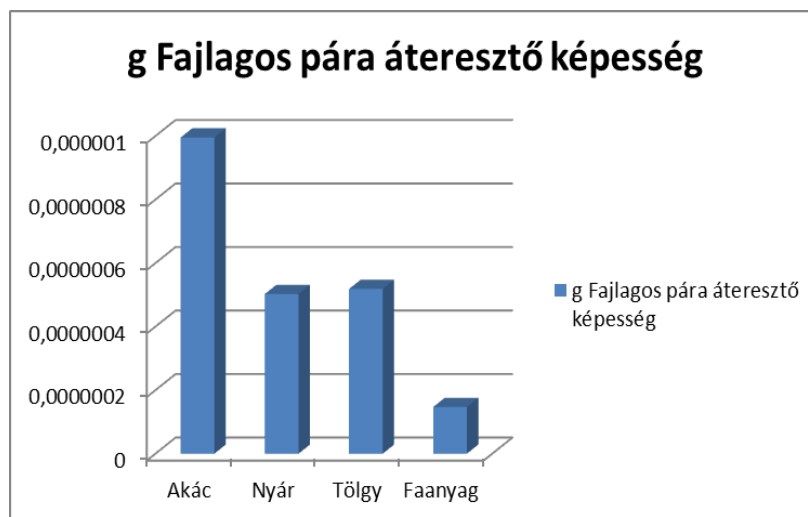
26. ábra Fajlagos páraáteresztő képesség összehasonlítása
