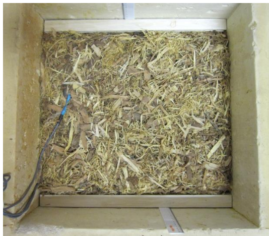
15. ábra A kéreg apríték minta elhelyezkedése a mérőműszerben
