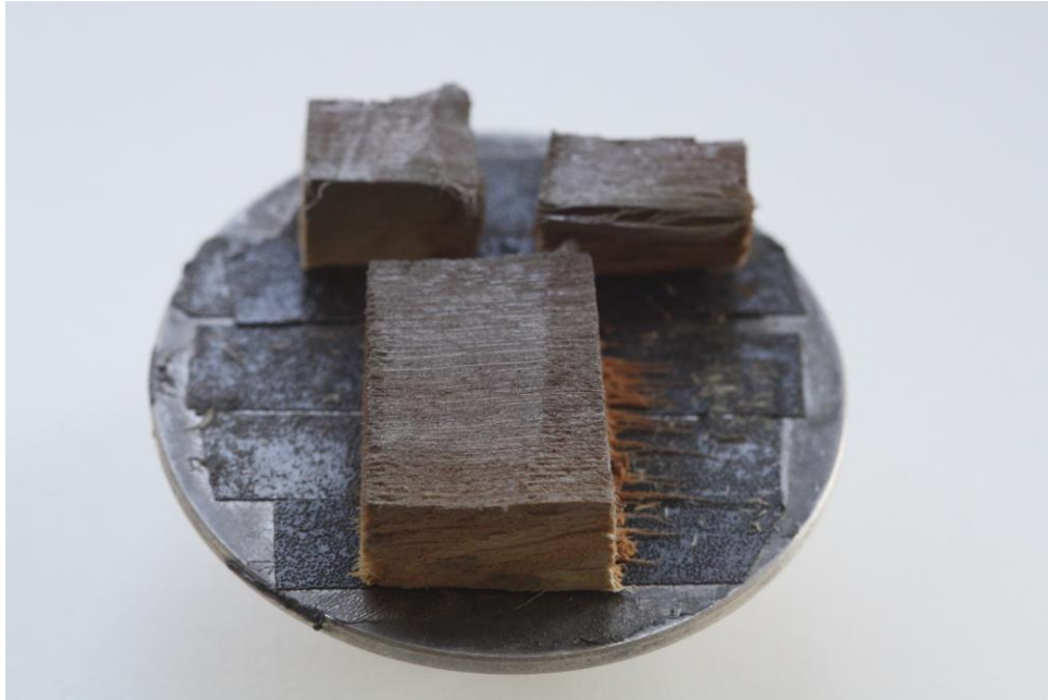
3. ábra Katódpásztázással készülő bevonat, bevonatos kéreg próbatetek
