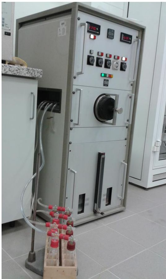
21. ábra A gázanalízis mérő berendezés
