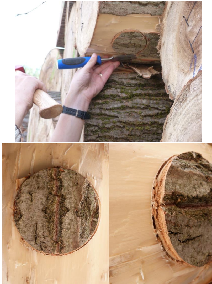
11. ábra A próbatetek kivágása
