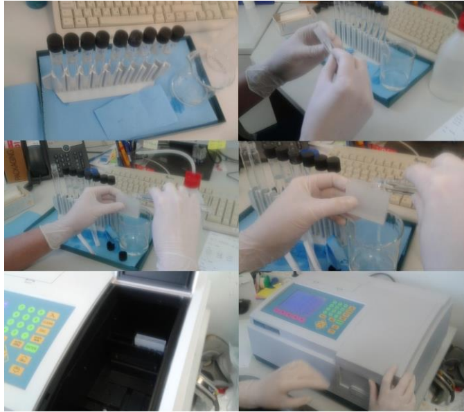
25. ábra A fotometriás vizsgálat menete
