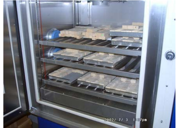
A bevizsgálandó minták a klímaszekrényben
