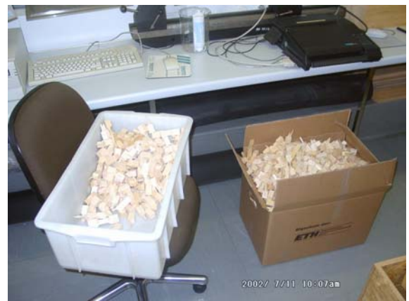
Próbatest tömegmérés kiszáritás előtt a vizsgálati nedvességtartalom megállapításához
