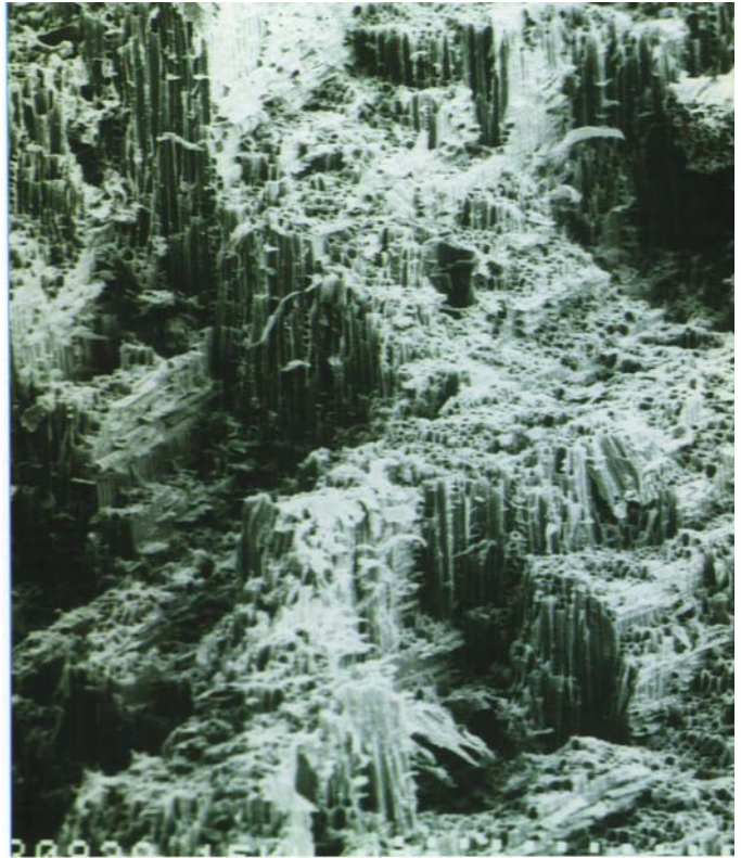
8.kép Akác törési képe, melyen mind húzási mind nyomási és nyírási tönkremenetel megfigyelhető.
