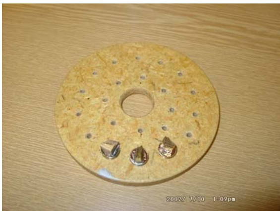
Az elektronmikroszkópos vizsgálatokhoz előkészített, bearanyozott törési felület minták
