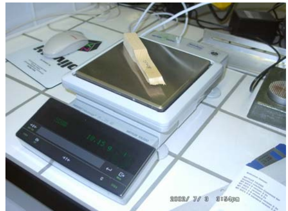
Próbatest tömegmérés kiszáritás előtt a vizsgálati nedvességtartalom megállapításához
