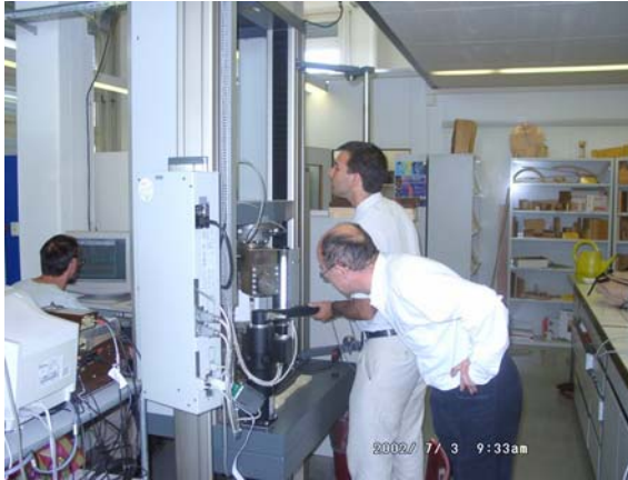
A mérőrendszer kalibrálása a mérések kezdetén (ETH. Zürich)
