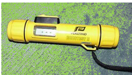
8. ábra – Plastimo Echotest II Ultrahangos mélységmérő
