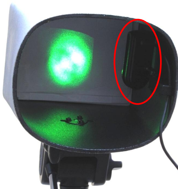
4.2.1.1. ábra: A lézert felfogó ernyő és a web kamera (pirossal körbevéve)
