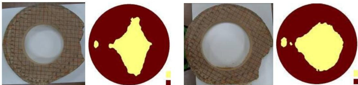
3.8.2.2. ábra: Ultrahangos tesztek korongokon.
