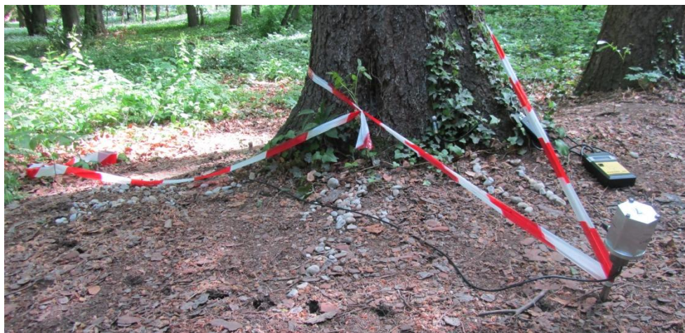
3.4.2. ábra: Gyökértérképező eszköz használatban
