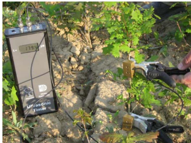
3.9.1.2. ábra: Ultrahangos mérés facsémétén
