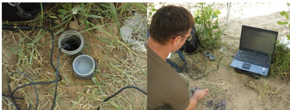
25-26. ábra : Telepített 4 m mélységű talajvízkút és adatainak kiolvasása (saját fotó)
