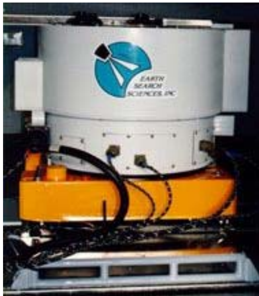
23. ábra: Az Earth Search Sciences Probe-1 típusú, 128 csatornás hiperspektrális szenzora (Forrás: Internet)
