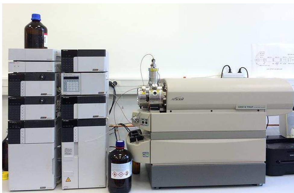
16. ábra A polifenolok elválasztására és meghatározására alkalmazott HPLC-PDA-MS/MS-készülék.
