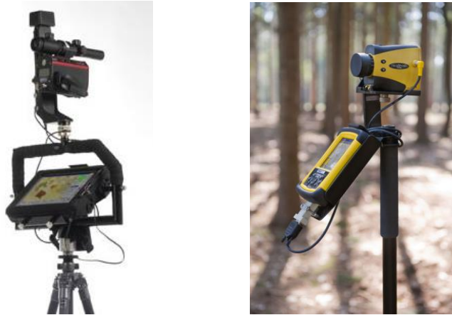
11. ábra: A „Field-Map” rendszer hardver összeállításai ( www.ifer.cz ).
