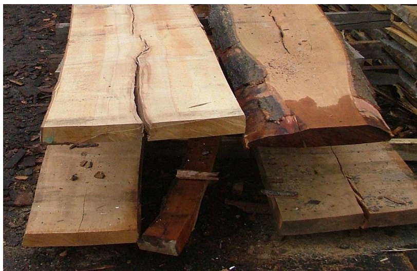
6.sz.kép. Jellegzetes, álgesztes -bél mentén végighasadt- fűrészárúk
