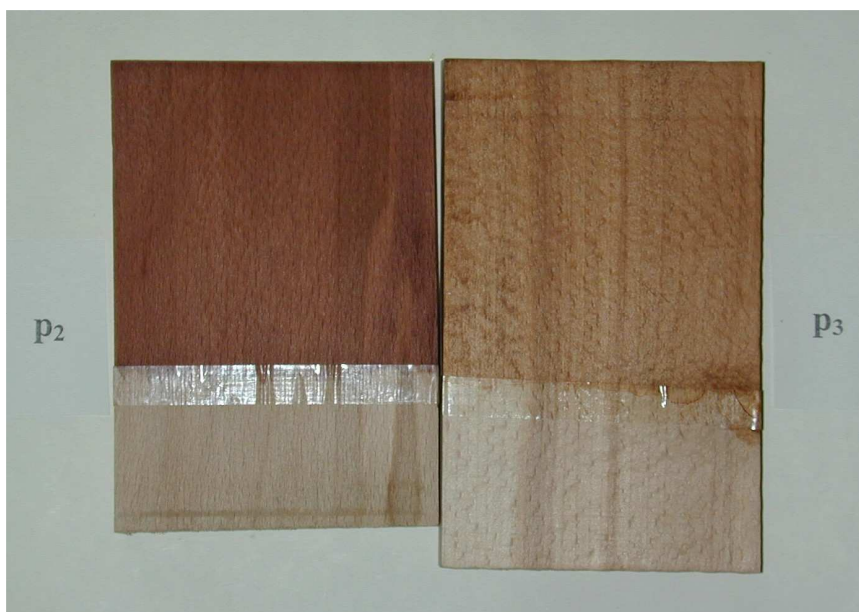
10.sz. kép. Sötét színű vizes és oldószeres pácok által elért kiegyenlítő hatás.
