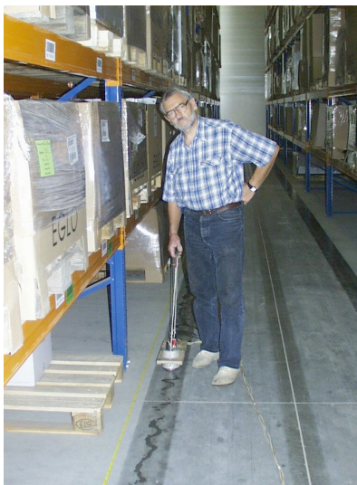
65. ábra. Akusztikus mérések rögzített adó-vevő távolságú eszközzel
