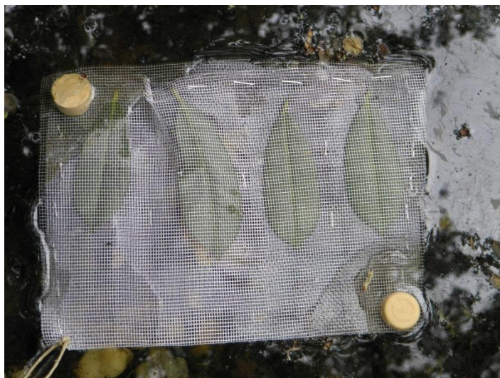
4.5. ábra: A vízi csapdázáshoz készített levélcsapda
