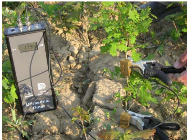
3.9.1.2. ábra: Ultrahangos mérés facsémteken
