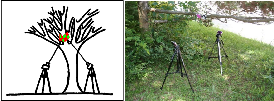
4.1.2. ábra: A két kamerás rendszer elméleti rajza (balra) és egy megvalósított mérés (jobbra)
