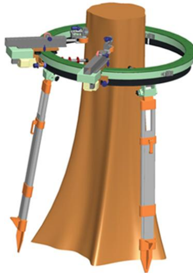
3.8.2.1. ábra: Egy élő fán végezhető ultrahang tomográfias mérés modellje
