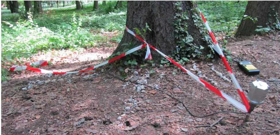
3.4.2. ábra: Gyökértérképező eszköz használatban
