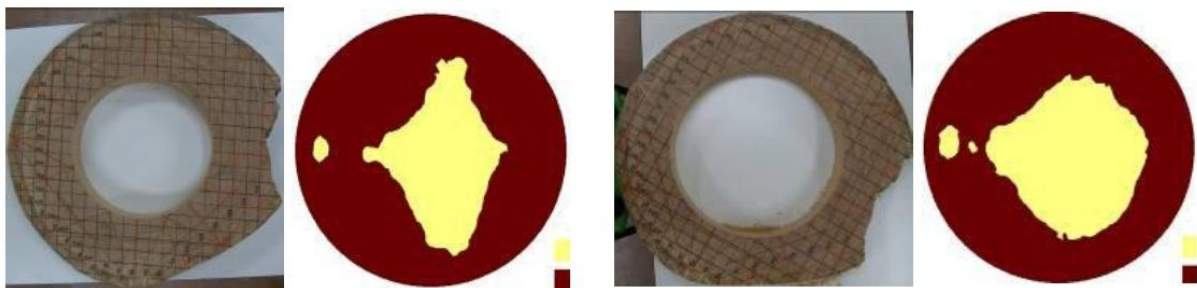
3.8.2.2. ábra: Ultrahangos tesztek korongokon.
